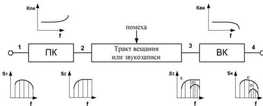
Рисунок 3.1 – Схема и спектры частотных предискажений
