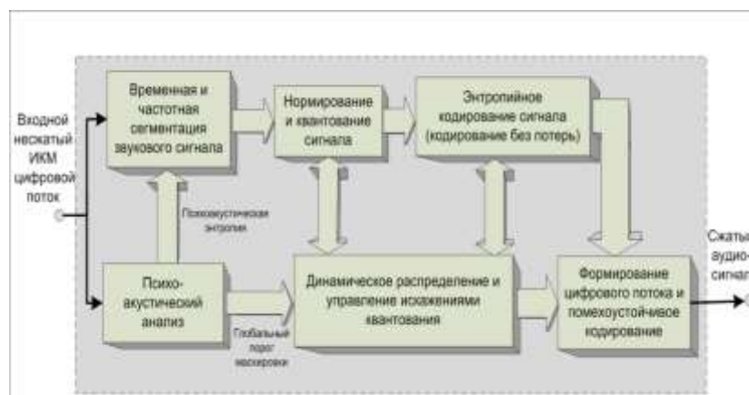
Рис. 6.6. Обобщенная структурная схема кодера с компрессией цифровых аудиоданных
