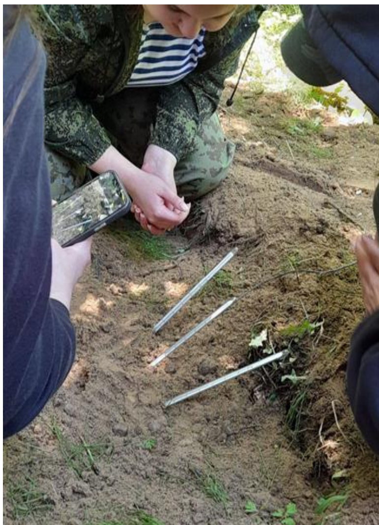
Рисунок 5 – Ход измерения температуры почвы термометром Савинова
