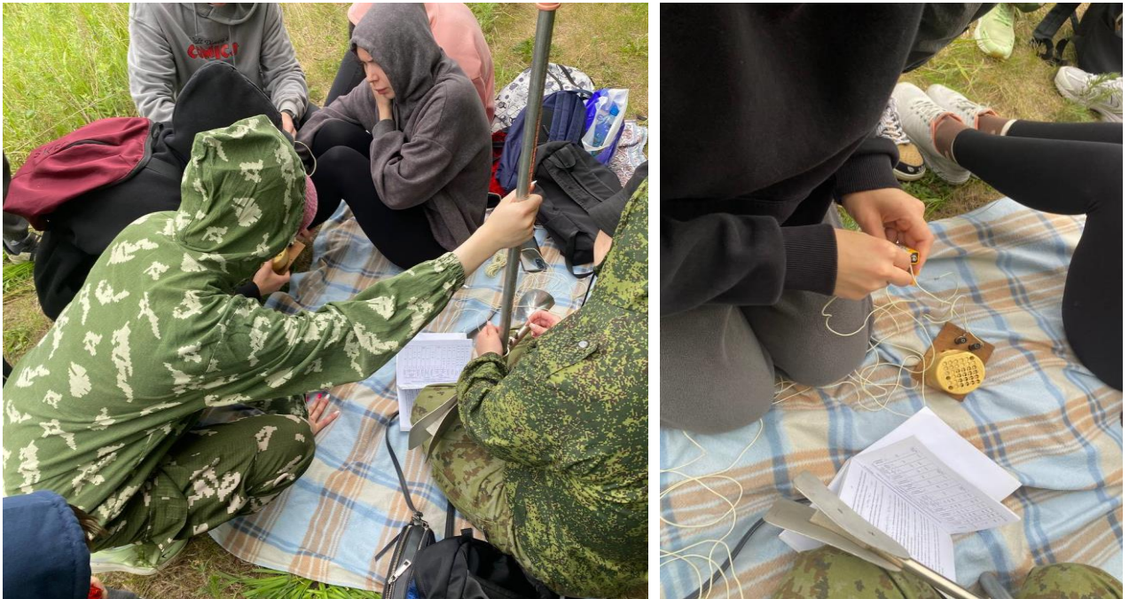
Рисунок 13 – Процесс сбора гидрометрической вертушки
