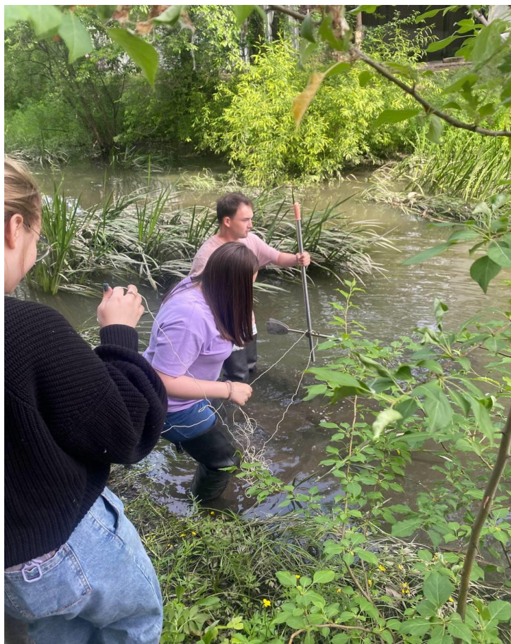
Рисунок 18 – Измерение скорости воды вертушкой
