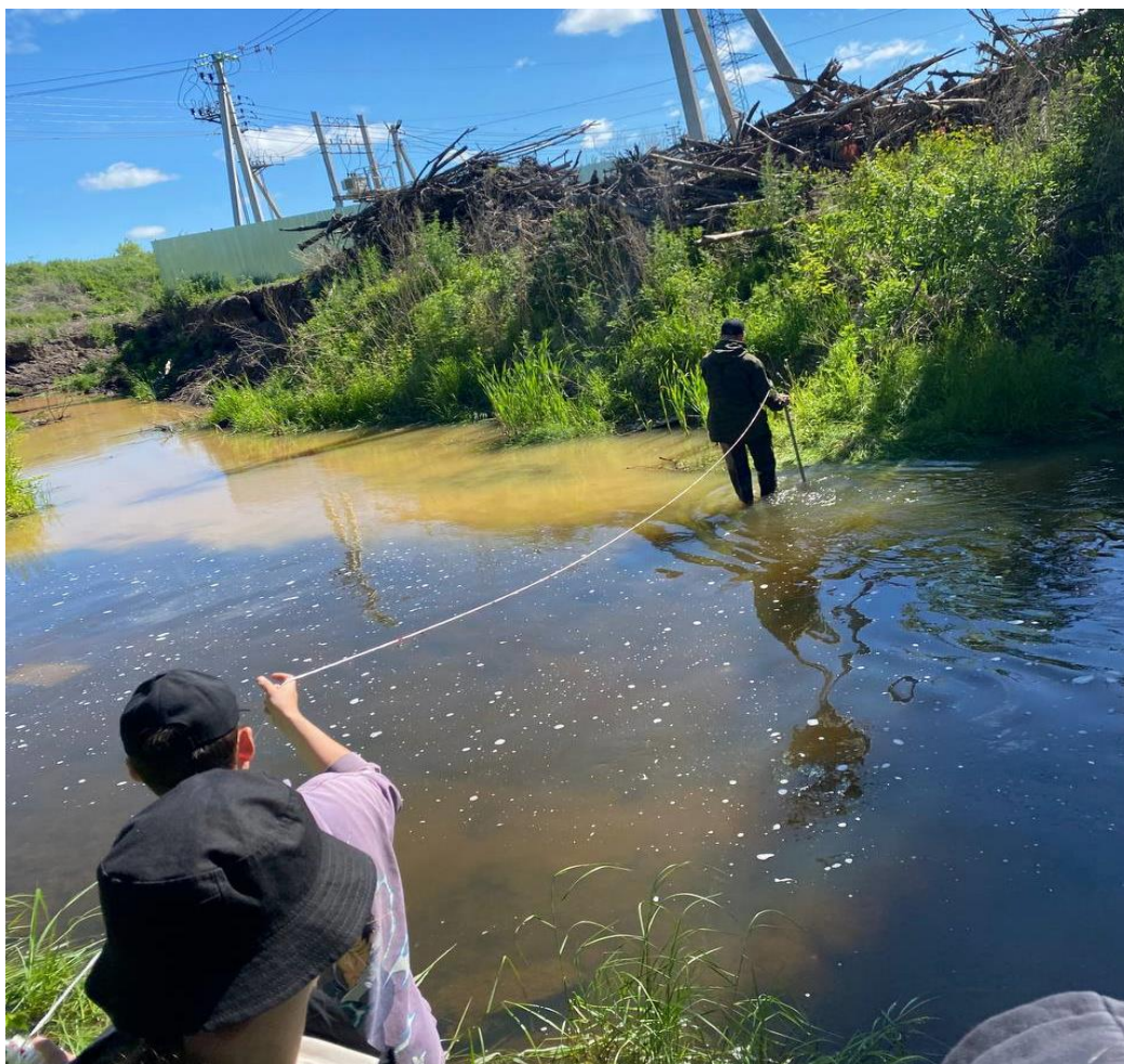
Рисунок 21 – Ход работы по натяжению троса на створе
