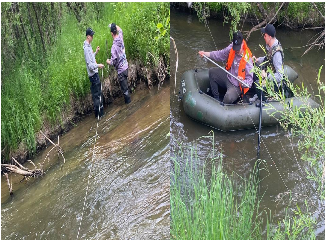
Рисунок 9 – Ход работы по натяжению троса на створе.
