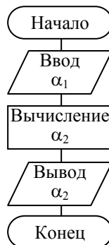
Рис. 7. Блок-схема алгоритма вычисления \alpha_2
