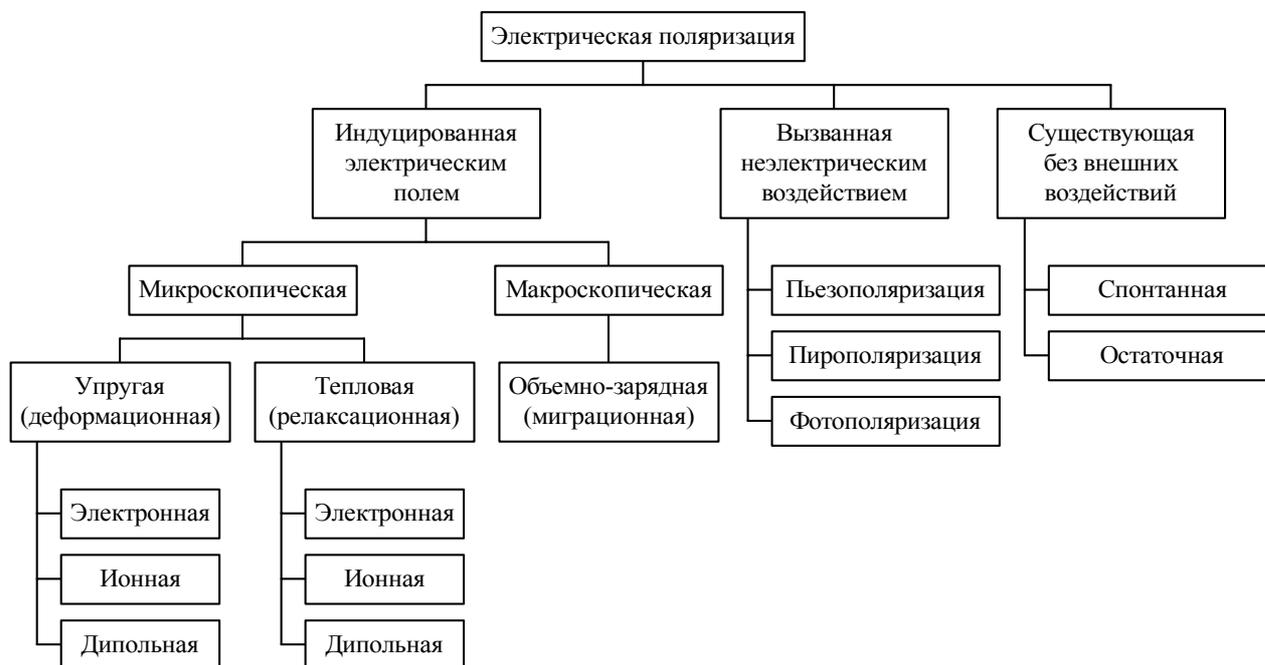
Рис. 10. Механизмы поляризации
