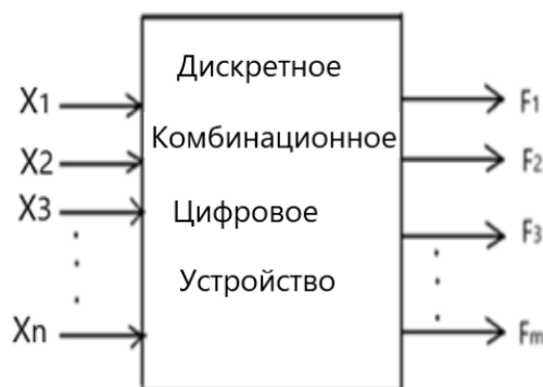
Рис.1.1. Обобщенная схема комбинационного цифрового устройства
