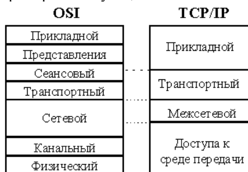
Рис. 3. Соотношение уровней стеков OSI и TCP/IP.
