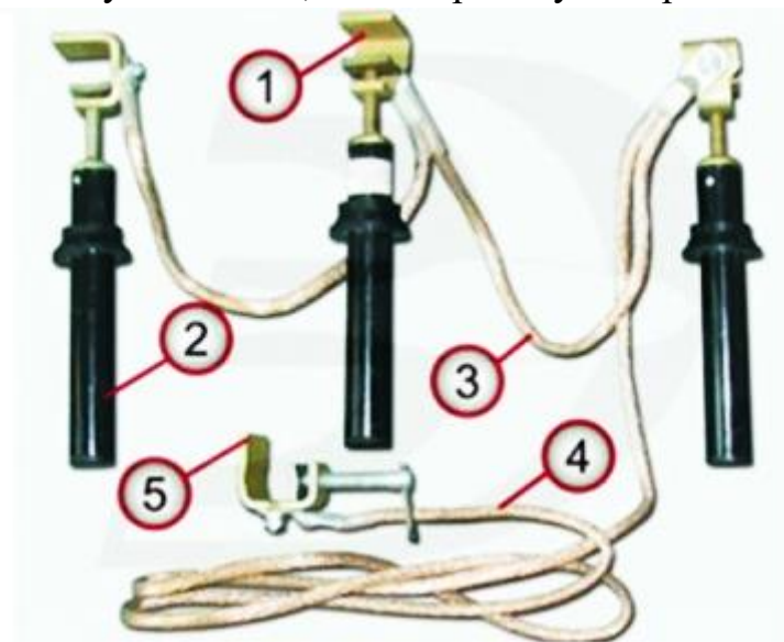
Рисунок 7.19 – Переносное штанговое заземление: 1 - фазные зажимы, 2 - штанги, 3 - закорачивающий провод, 4 - заземляющий провод, 5 - зажимы
