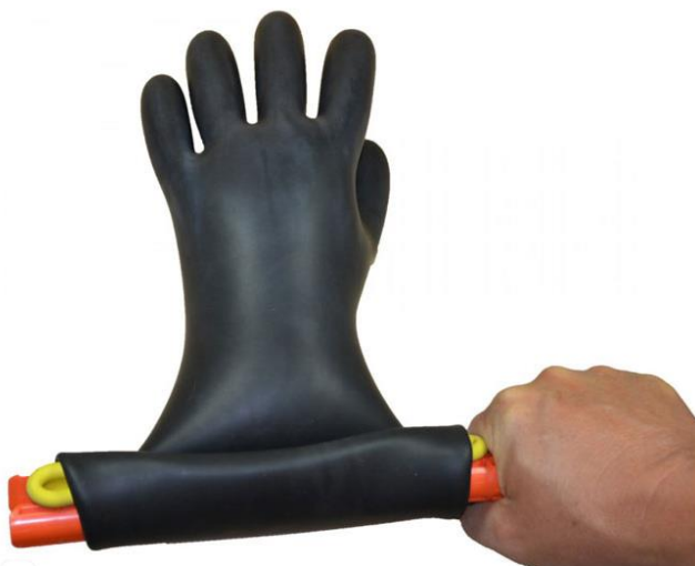
Рисунок 7.12 – Проверка диэлектрических перчаток перед применением, методом скручивания
