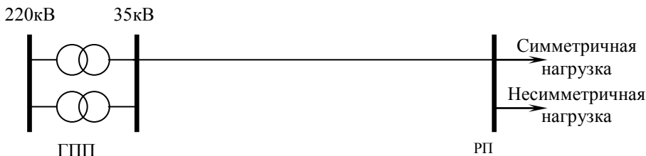
Рис.9.4. Схема неправильного подключения мощной однофазной нагрузки.
