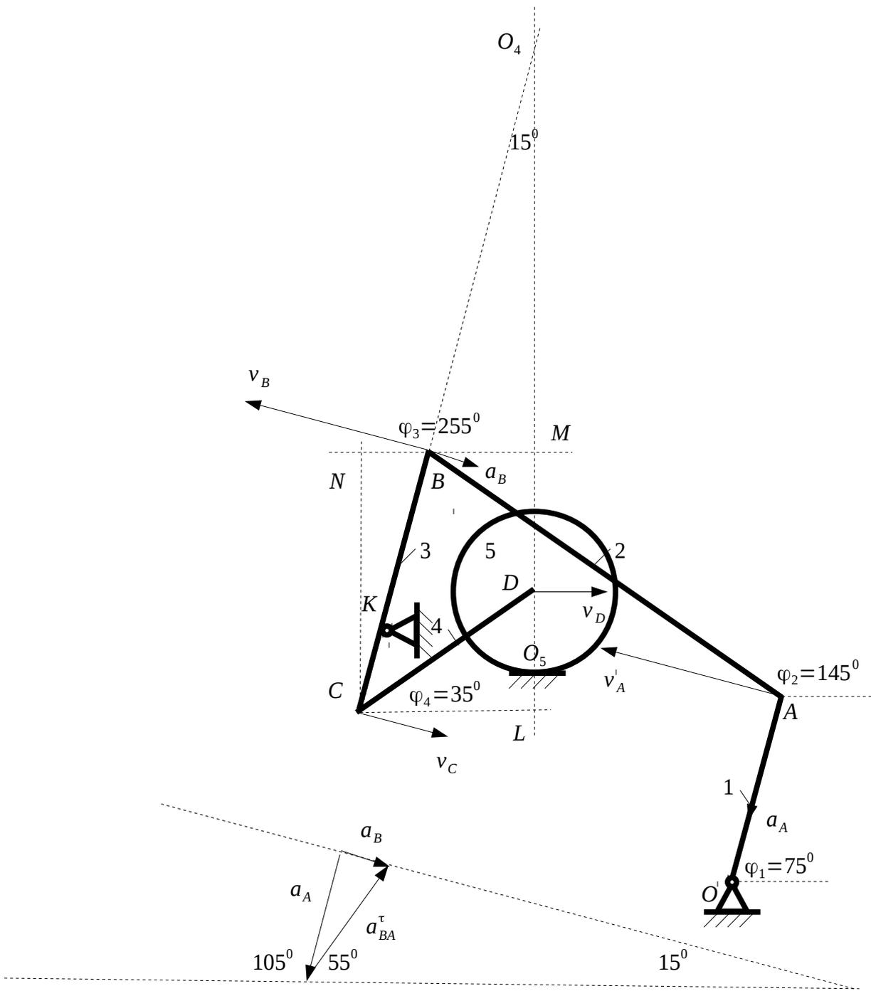
Стержень 1 совершает вращательное движение против часовой стрелки вокруг точки O.
